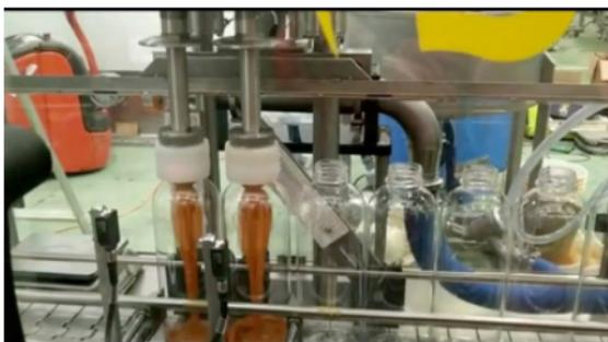
*\*Detalle boquillas de dosificación*
